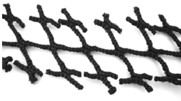
Figur 8 Form på prøve brukt i styrketest.
